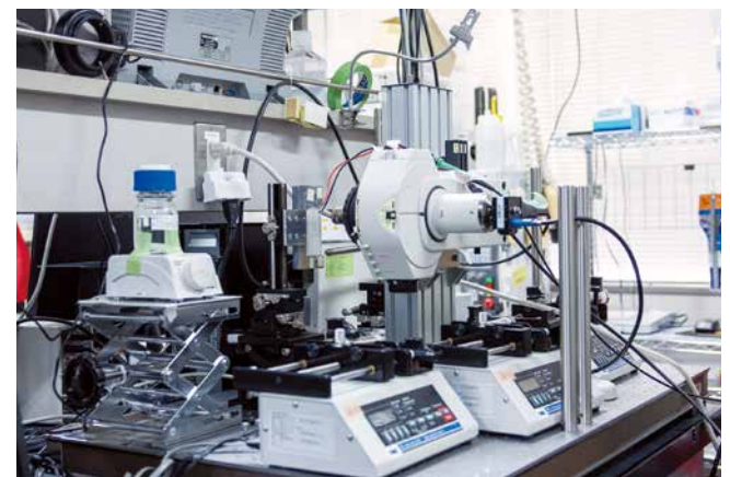
音響収束を用いたマイクロプラスチックの濃縮回収デバイス観測装置
