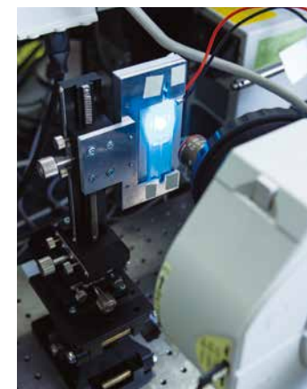
音響収束を用いたマイクロプラスチックの濃縮回収デバイス観測装置
